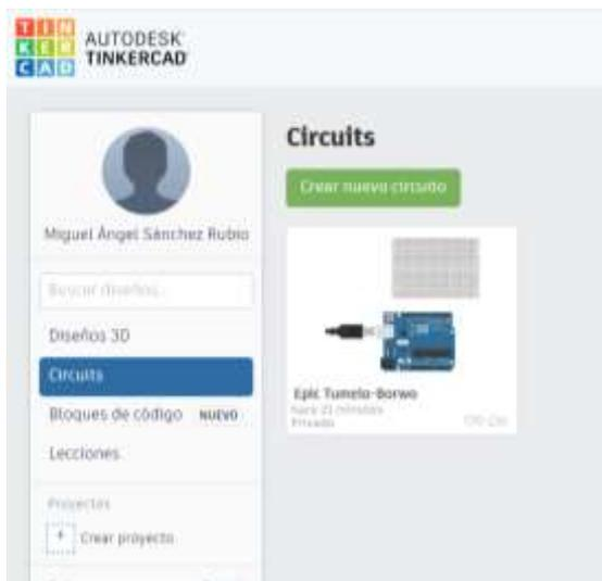
Y es muy intuitivo. A la derecha tenéis los elementos electrónicos. Los grandes, como la placa controladora de Arduino y la placa protoboard, pinchas y aparecen en el tablero (los puedes mover, puedes hacer zoom con la rueda del ratón...). Los más pequeños, como resistencias o leds, pinchas y arrastras. En cada elemento puedes modificar sus características (como el valor de la resistencia).
