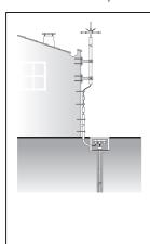
Las instalaciones de pararrayos consisten en un mástil metálico con un cabezal captador. El cabezal está unido a una toma de tierra eléctrica por medio de un cable de cobre conductor. La toma de tierra se construye mediante picas de metal enterradas en el terreno. (Wikipedia)
